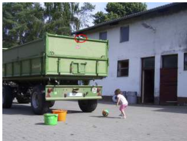
Das hinter dem Fahrzeug spielende Kind nimmt die Gefahr nicht wahr. Mit einer Rückfahrkamera aber hat der Fahrer alles sicher im Blick. Foto: SVLFG
